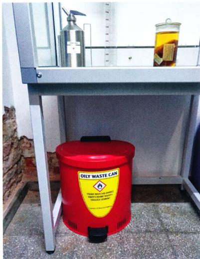
Abb. 1: Feuerfester Behälter zur Entsorgung verschütteter und aufgenommener Konservierungsflüssigkeit.
