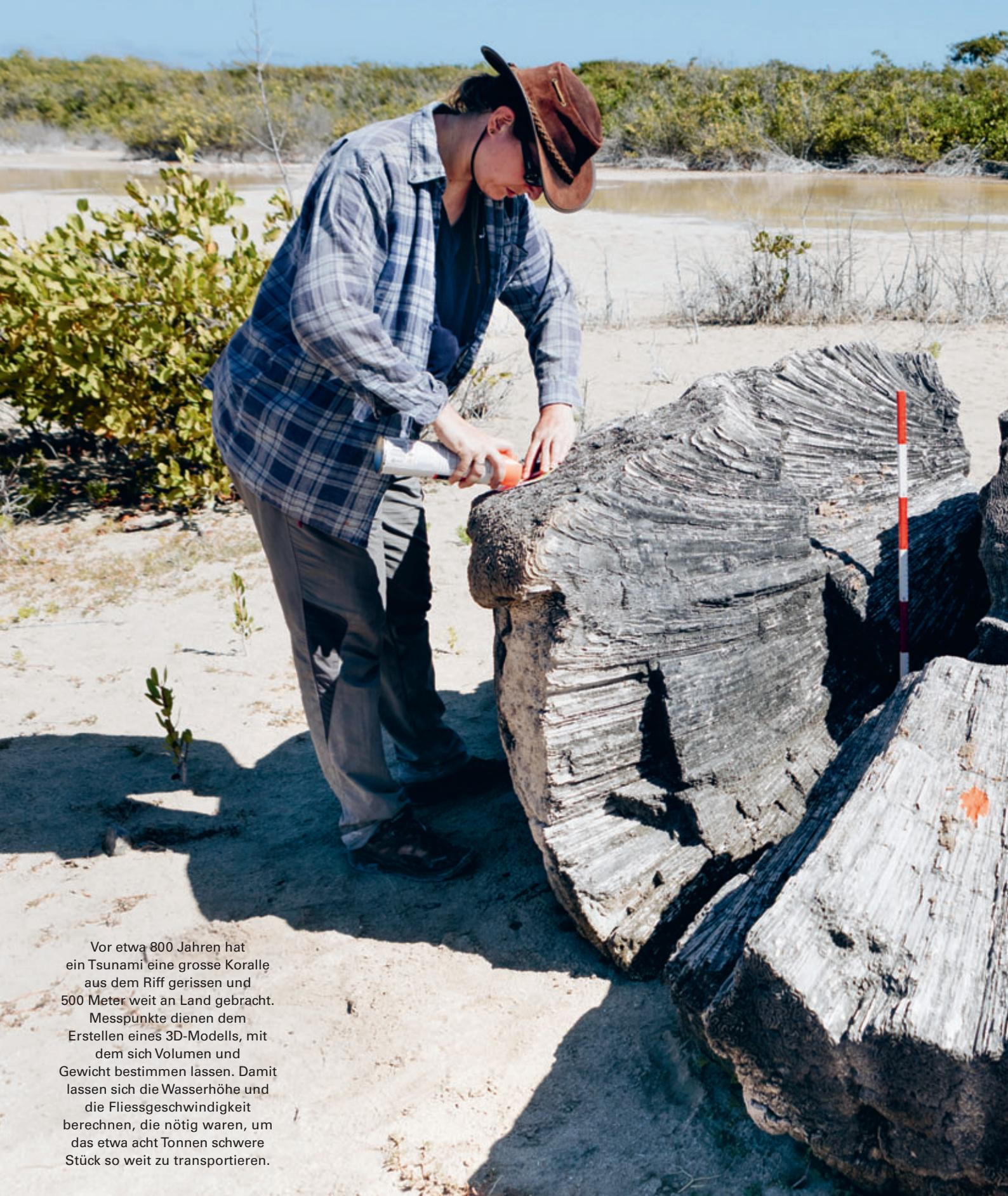
Vor etwa 800 Jahren hat ein Tsunami eine grosse Koralle aus dem Riff gerissen und 500 Meter weit an Land gebracht. Messpunkte dienen dem Erstellen eines 3D-Modells, mit dem sich Volumen und Gewicht bestimmen lassen. Damit lassen sich die Wasserhöhe und die Fließgeschwindigkeit berechnen, die nötig waren, um das etwa acht Tonnen schwere Stück so weit zu transportieren.
